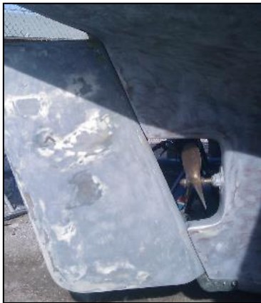
γ) Shaft, not exposed (κρυμμένος άξονας χωρίς μπρακέτο)-2, "skeg"
