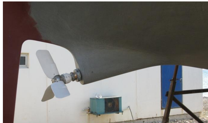
γ) Shaft, not exposed (κρυμμένος άξονας χωρίς μπρακέτο)-2, "skeg"
