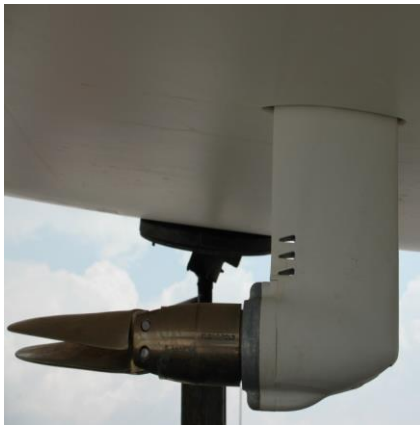
γ) Shaft, not exposed (κρυμμένος άξονας χωρίς μπρακέτο)-2, "skeg"
